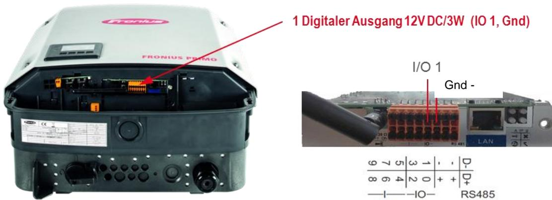
Abbildung 5: Anschluss am Fronius Datamanager 2.0 für das Energiemanagement.
