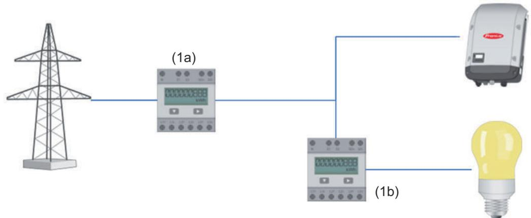
È possibile collegare un contatore per la rilevazione dell'autoconsumo tramite SO direttamente all'inverter (solo per Fronius Galvo, Fronius Symo Fronius Primo e Fronius Eco).
