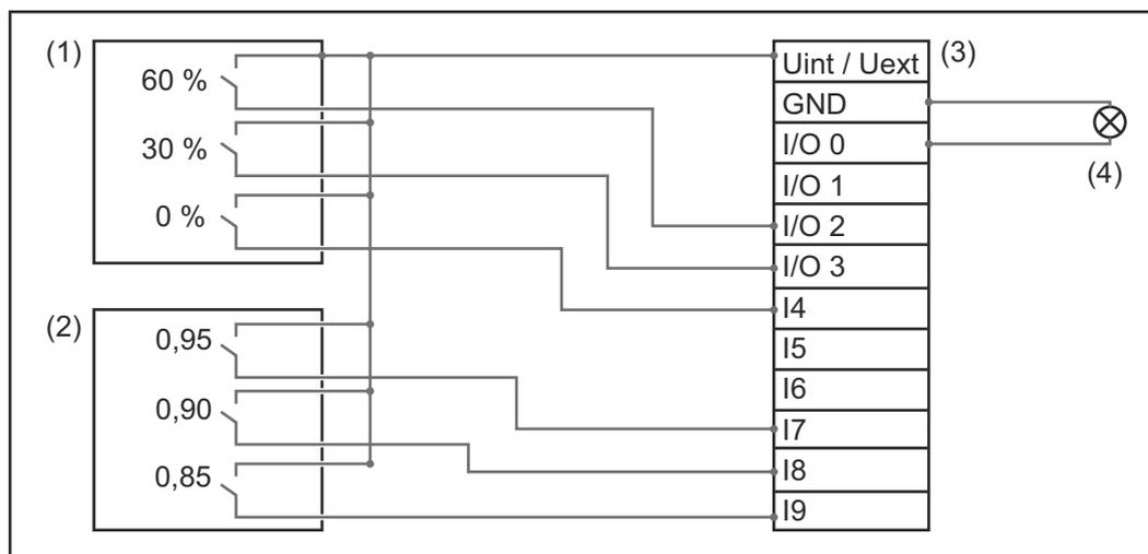
Il ricevitore di segnali di comando centralizzati e la spina di "Fronius Datamanager" sono collegati tra loro rispettivamente mediante cavo a 4 poli secondo lo schema dei collegamenti.
