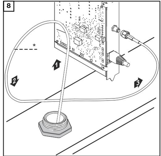
Raggio di curvatura del cavo dell'antenna: min.
